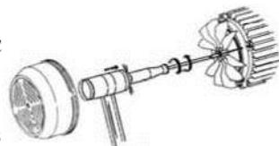
Переконайтесь, що напрямок обертання двигуна збігається із вказаним на таблиці з технічними параметрами (вентилятор повинен обертатися за годинниковою стрілкою, якщо дивитися з боку задньої частини двигуна). Якщо насос є трифазним і напрямок обертання не збігається із зазначенім, необхідно інвертувати дві фази електричного живлення захисної панелі.
