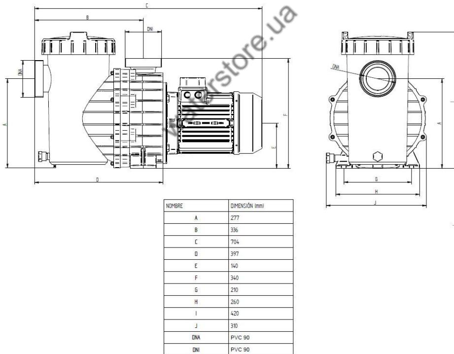
Нанос повинен бути встановлений на тверду та гладку поверхню та міцно закріплений за допомогою 2 гвинтів або інших кріпильних елементів, використовуючи спеціальні отвори, розташовані в основі насоса. Це допоможе уникнути можливих шумів і вібрацій, які можуть негативно вплинути на роботу насоса.
