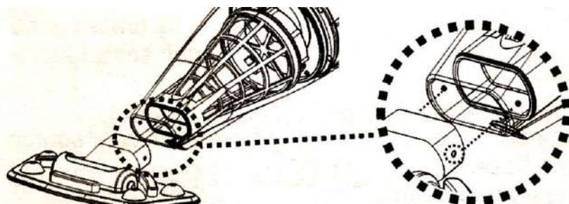
**ПРИМЕЧАНИЕ:** для замены щетки на всасывающей насадке, поднимите один конец щетки и вытащите ее, чтобы освободить место для новой.
