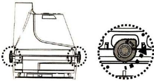
3. Наклоните фильтровальный конус, конец с меньшим диаметром должен быть направлен вверх. Затем вытяните фильтровальный конус из прозрачного контейнера. Удерживайте конус горизонтально и поверните его крышку по часовой стрелке, чтобы отсоединить ее от фильтровального конуса.
