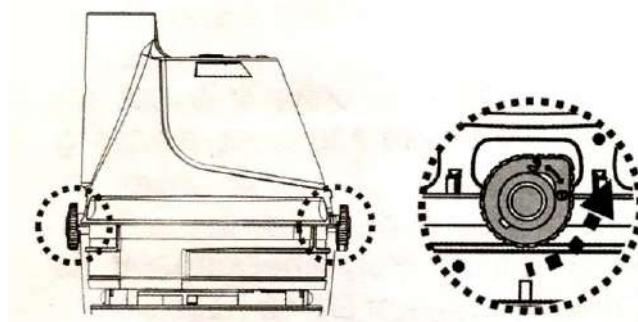
2. Установите задний корпус на плоскую поверхность (вверх дном, кнопка ВКЛ/ВЫКЛ питания направлена вверх). Совместите и сдвиньте защелку зарядного устройства в боковой паз на нижней поверхности заднего корпуса, пока защелка не зафиксируется. Убедитесь, что контактные пластины контактируют надлежащим образом. Подключите гнездо наружного переходника к зарядному устройству на торце зарядного устройства.
