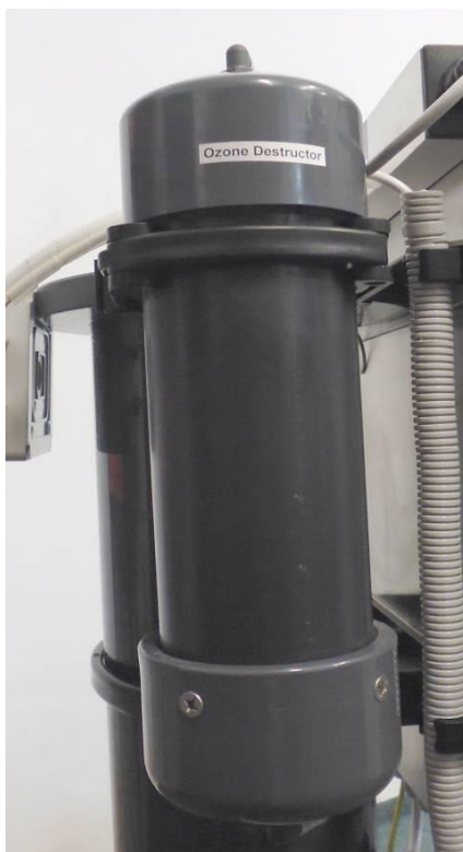
Рис. 8 Деструктор остаточного озона
