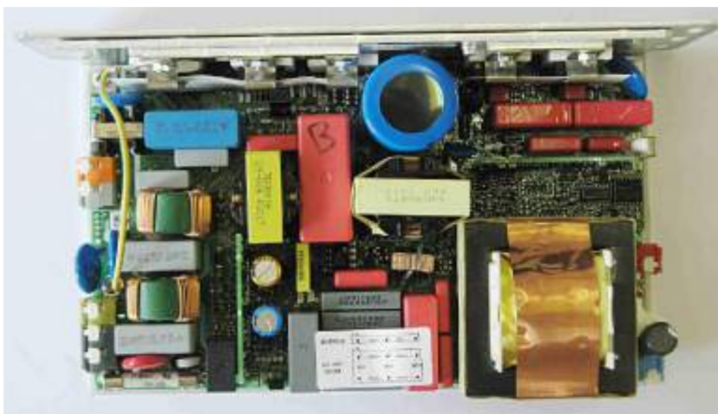
Рис. 25 Электронный балласт УФ разрядной лампы
